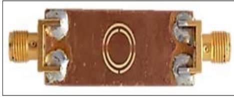
Fig. 3: a) CSRR circulaire sur substrat de FR4 .b) Dispositif de mesures microondes avec contrôle de pression sur les échantillons.
