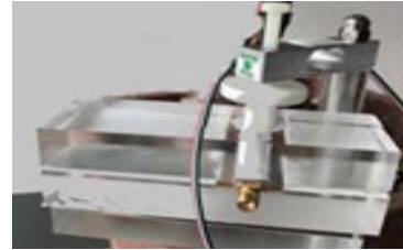
Fig. 3: a) CSRR circulaire sur substrat de FR4 .b) Dispositif de mesures microondes avec contrôle de pression sur les échantillons.
